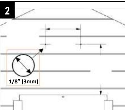
Marquez deux positions de trous à 4 ¾" (121mm) l'une de l'autre et à environ 6 ½" (170mm) au-dessus du haut de la porte coulissante. Assurez-vous qu'ils sont de niveau et régulièrement espacés au-dessus du centre de la porte. Faites les trous avec une mèche de 3,0 mm ou un poinçon.
